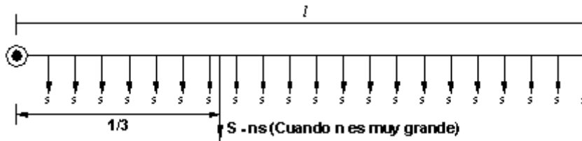
FIGURA 5.2. Localización de cargas para el cálculo de pérdidas en una línea con carga uniformemente distribuída
